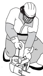
**VAROVÁNÍ!** Nevytahujte celou délku lanka startérů, nepouštějte startovací madlo a nenechávejte plně vytážené lanko samovolně navýjet. To by mohlo stroj poškodit.
