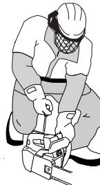
**NEZABUDNITE!** Šnúru štartéra nevyťahujte naplno a nepúšťajte držadlo štartéra pri plnom vytiahnutí šnúry. Môže to poškodiť stroj.
