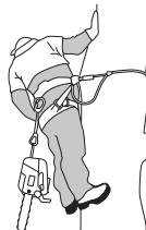
Sae kinnitamisel ühest kinnituspunktist teise peab operaator veenduma, et saag on enne vana kinnituse avamist uude kohta kinnitatud.
