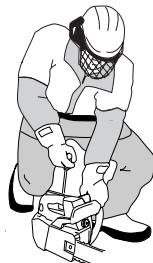
**UWAGA!** Nie wyciągaj linki rozrusznika całkowicie i nie puszczań jej nagle, gdy jest wyciągnięta. Może to spowodować uszkodzenie maszyny.
