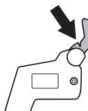
フロントハンドガードを前後に動かしてみて、スムーズに動くか、クラッチカバーで確実に止まるかなどを点検します。
