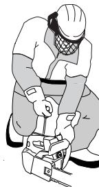
**FIGYELEM!** Ne húzza ki az indítózsinort teljesen, és ne engedje el az indítófogantyút, ha a zsinór teljesen kihúzott állapotban van. Ez a gép károsodását okozhatja.
