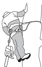
Pokud je pila přemisťována z jednoho připojovacího bodu do druhého, je třeba se ujistit, že je zajistěna v nové poloze předtím, než bude odpojena od předešlého připojovacího bodu.
