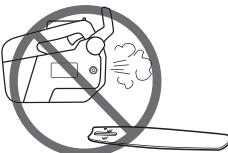
• チェンソーを始動する際は、必ずチェンブレーキをかけてください。始動方法は「始動と停止」を参照してください。チェンソーは中に浮かせて始動しないでください。こうしたやりかたは、チェンソーのコントロールを失いやすく、極めて危険です。
