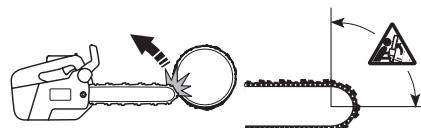
キックバックは、常にガイドバーの切削面で起ります。通常、チェンソーがガイドバーを先にして、使用者の方に斜め上にはじき返されます。ただし、キックバックゾーンが何かに触れたときのチェンソーの使い方により、異なる方向にはじき返されることもあります。
