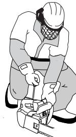
**VAROVÁNÍ!** Nevytahujte celou délku lanka startérů, nepouštějte startovací madlo a nenechávejte plně vytážené lanko samovolně navíjet. To by mohlo stroj poškodit.
