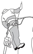
Ha a kezelő át szeretné helyezni a láncfűrészt az egyik csatlakoztatási pontról a másikra, akkor előbb rögzítenie kell a fűrészt az új helyen, mielőtt az előző csatlakoztatási pontról lecsatolná.
