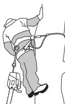
Przenosząc pilarkę z jednego punktu zamocowania do innego, operator musi zapewnić, że jest ona zabezpieczona w nowej pozycji przed zwolnieniem jej z poprzedniego punktu zamocowania.
