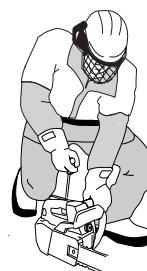
**UWAGA!** Nie wyciągaj linki rozrusznika całkowicie i nie puszzaj jej nagle, gdy jest wyciągnięta. Może to spowodować uszkodzenie maszyny.
